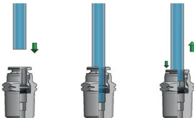
Effettuato il collegamento, assicurarsi che il tubo inserito nel raccordo non sia sottoposto ad alcuna forza di trazione; è necessario inoltre rispettare durante il collegamento del tubo il raggio minimo di curvatura consigliato così come riportato nella sezione tubi se fornite da noi
