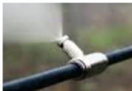
le tubazioni che solitamente si utilizzano sono 6 o 10mm e resistono da 35 a 100 bar di pressione quindi possono essere posizionate direttamente sul terreno senza protezioni. i raccordi resistono fino a 70 bar e sono in acciaio INOX oppure OTTONE NICHELATO, quindi idoneo ad essere installati all'esterno
